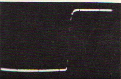
L'essai en signaux rectangulaires montre l'excellent comportement de l'amplificateur, aux fréquences basses comme aux fréquences élevées. Les temps de commutation ne sont que de  $4 \mu s$ .
